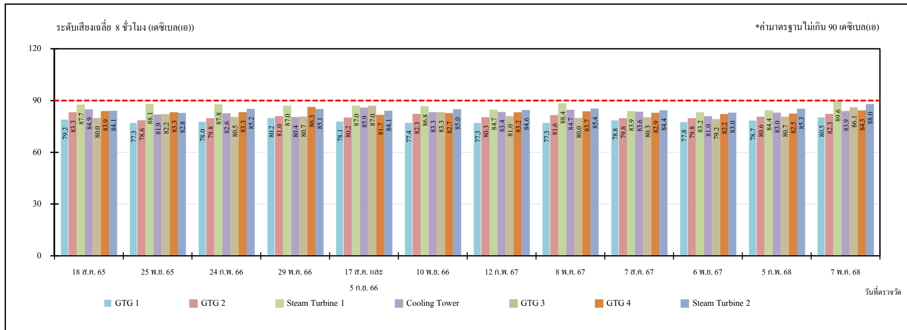
รูปที่ 4.4-2 กราฟผลการตรวจวัดระดับเสียงในสถานที่ทำงาน โรงไฟฟ้าพลังความร้อนร่วมบางปะอิน บริษัท บางปะอิน โกลเดนเนอเรชั่น จำกัด ระหว่างปี พ.ศ.2565-2568
